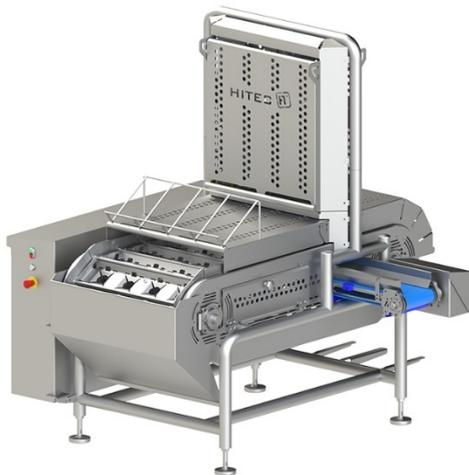
Neue Generation: Das PDS4L System eignet sich perfekt zum Entstrunken und Segmentieren von Paprika
