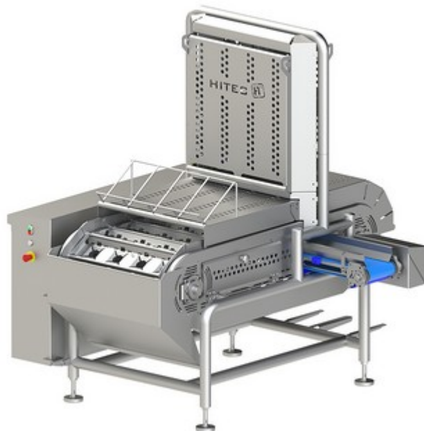
Die PDS4L Paprika Entstrunk- und Teilmaschine aus dem Hause Kronen
