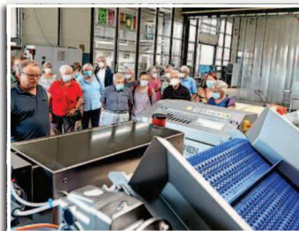
◀ **Effizient:** Die meisten Maschinen sind für den Einsatz in Großküchen, in der Industrie und im Catering entwickelt. Sie machen in einer Stunde zwischen 500 Kilo und zwei Tonnen Obst und Gemüse verzehrfertig.
