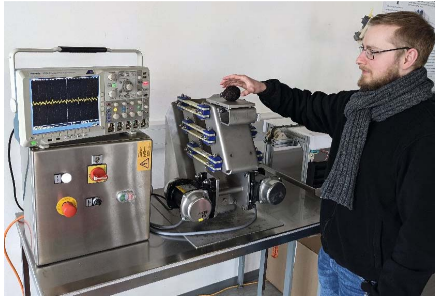
DIL-Mitarbeiter Thorsten Lameyer mit einem Prototyp des Vibrationsförderers. Foto: DIL
