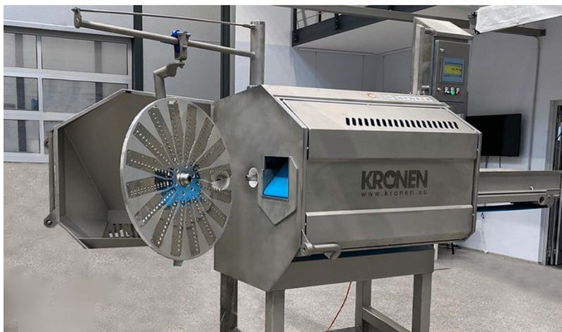
Der Schwenkarm dient zum einfacheren Austausch der Messerscheiben. Er wurde überarbeitet, um Hohlräume zu eliminieren und Verschraubungen zu reduzieren. Die neue Funktion zum Fixieren des Schlittens erhöht die Arbeitssicherheit.
