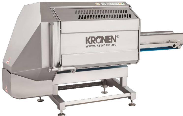
Die GS 20 ist eine flexibel einsetzbare Bandschneidemaschine mit hoher Verarbeitungskapazität.
