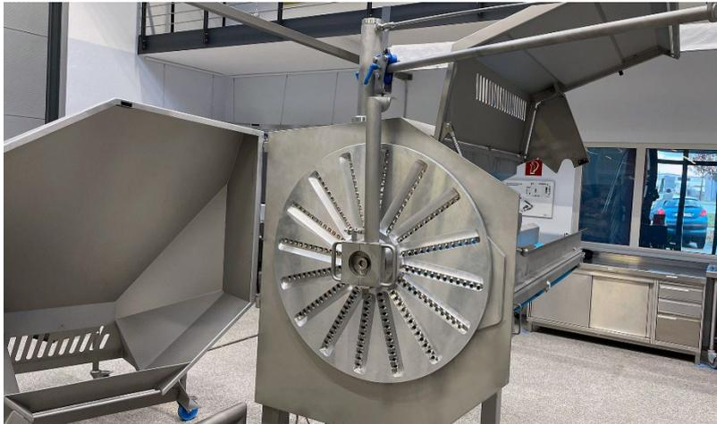
Der Schwenkarm ist ein optional erhältliches Zubehör zur Bandschneidemaschine GS 20. Mit seiner Hilfe können die Messerscheiben einfacher gewechselt werden.
