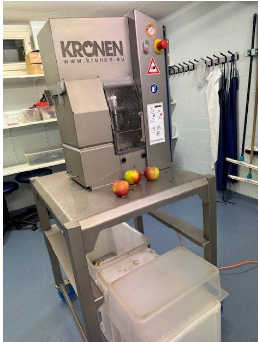
Die Apfelschälmaschine AS 6 von KRONEN vereinfacht die Apfelverarbeitung bei der Stiftung Kartause Ittingen.
